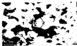
Рис. 3. Вкрапленная руда – метасоматит (1); сфалерит (2) различного цвета – от светло-желтого (клеюфан) до темно-коричневого (марматит); не просвечивающийся рудный минерал (3). Шлиф, увеличено 100 \times
