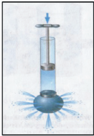
Şəkil 3. Porşenin altındakı suyu sıxdıqda su şırnağı əmələ gəlir.
