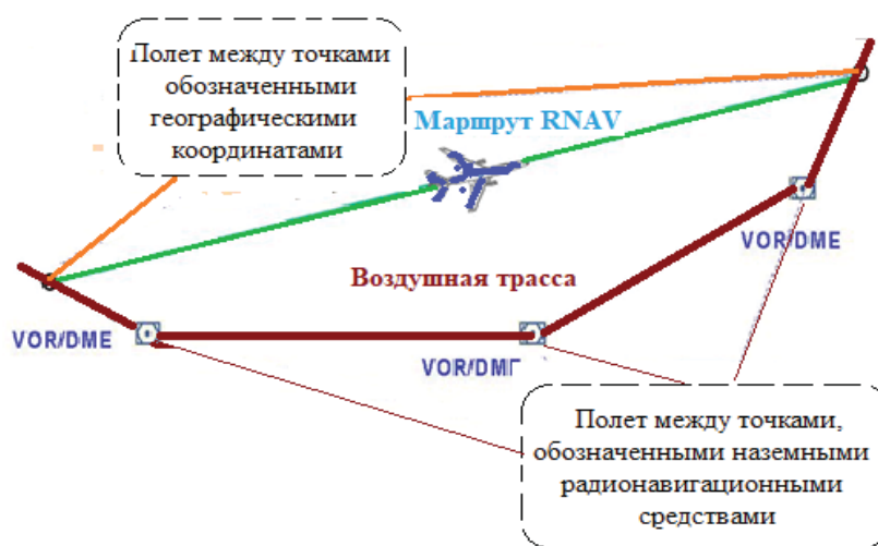
Рис.4. Упрощенная схема, показывающая основное различие между традиционной навигацией и методами зональной навигации (RNAV)
