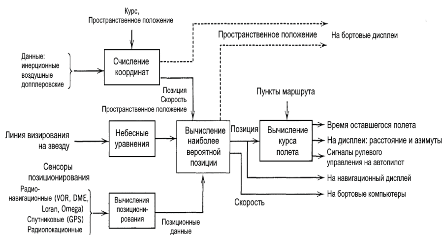
Рис.2. Обобщенная структурная схема навигационной системы ВС для обеспечения ППП
