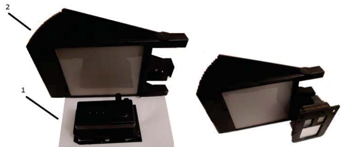
Şəkil 2. AC-2 ayırdetmə cihazı "Ekran" qurğusu ilə birlikdə 1 - AC-2 ayırdetmə cihazı, 2 - "Ekran" qurğusu
