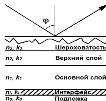
Рис.1. Многослойная модель лакокрасочного покрытия
