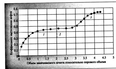
Рис. 1. Вытеснение нефти пластовой водой (1), а затем вытеснение остаточной нефти созданием пенной оторочки (2) при последующей закачке пластовой воды (3)
