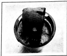
Рис. 7. Минипакер в затвердевшем цементе, извлеченный из водяной бани (резиновые полоски извлечены из цемента)
