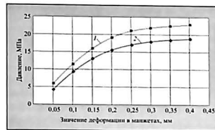
Рис. 3. Зависимость деформации в манжетках от давления: 1 – теоретическая; 2 – экспериментальная
