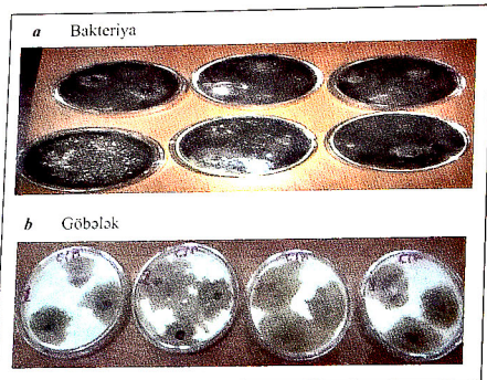
Şəkil 2. M-12BБ motor yağının biosidsiz (a) və \alpha -furiil- \beta -nitroeten biosidi ilə (b) bioloji davamlığının sınaq nəticələri
