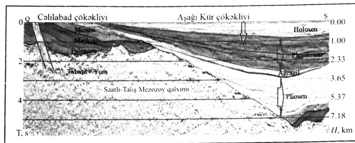
Şəkil 4. Saatlı-Talış Mezozooy qalxımını və Qərbi Xəzər dərinlik qırılmasını ŞmQ-CS istiqamətində kəsən xətt (şəkil 1-də III-III xətti) üzrə seysmik zaman kəsilişi. Xəttin sağ tərəfində Qərbi Xəzər dərinlik qırılmasının yeri qırmızı rəngli ox ilə işarə edilmişdir. Göründüyü kimi, geoloji kəsilişin Kaynozoy ə aid hissəsində tektonik dislokasiya yer almır
