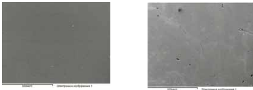
Şək.1. Cd 1-x Fe x Te (x=0.05) epitaksial təbəqələrinin səth morfologiyasının SEM şəkilləri: a) Dγ=0. b) Dγ=50 kQr
