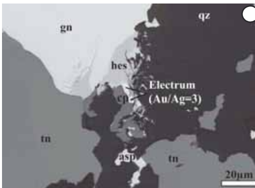
Şəkl. 1. Elektrumun qalenit-tennantit minerallaşmasında görünüşü. ad- adulyar, cp-xalkopirit, gn-qalenit, hes-hessit, qz-kvars, tn-tennantit
