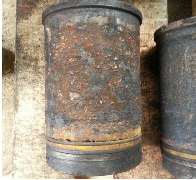
Şəkil 1. Xarici səthi korroziyaya uğramış silindr oymağı
