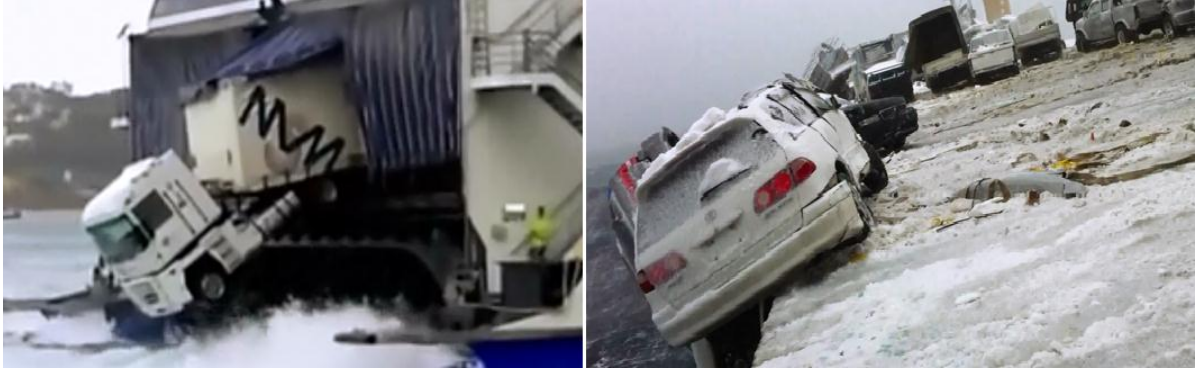
Şək. 2. Yükün gəmidə düzgün bərkidilməməsi
