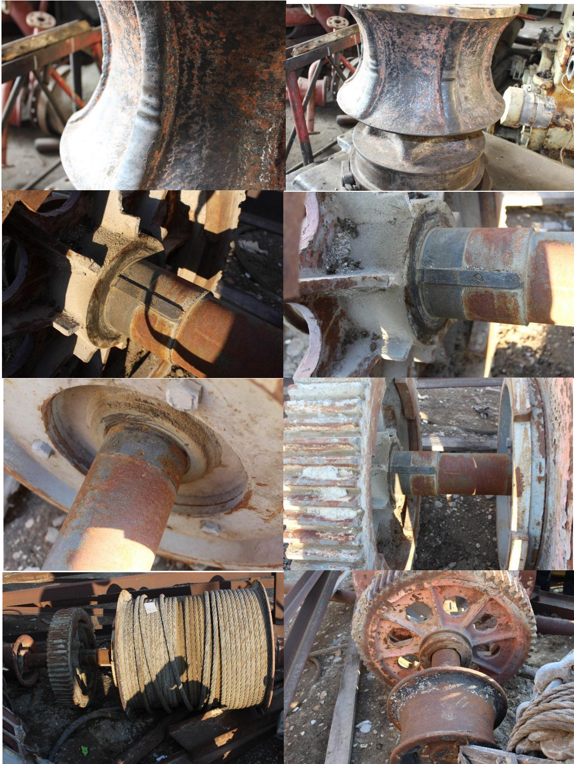
Şəkil 2. Braşpilin yük valının üzərindəki zəncirin ağırlığı nəticəsində həm zəncirdə, həm də barabanda sürtünmə və yeyilməni əks etdirən görüntülər.
