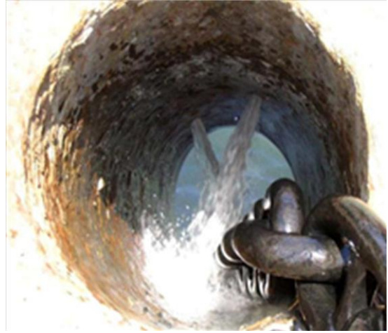
Şəkil 1. Zəncirin lövbər borusunda yuyulması.
