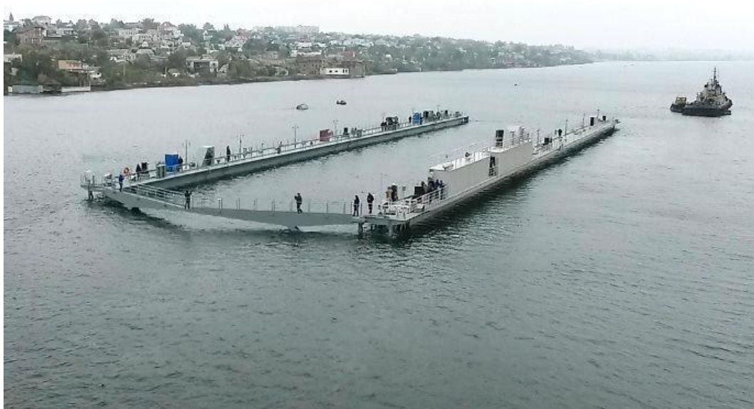
Рис. 11. Испытания композитного автономного плавучего дока "ERENEOS" грузоподъемностью 7100 тонн
