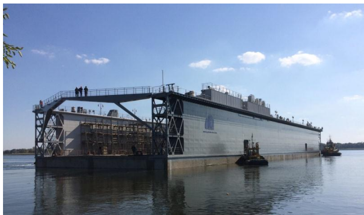
Рис. 1. Композитный плавучий док грузоподъемностью 7100 т, построенный на Херсонском государственном заводе «Паллада» [2]
