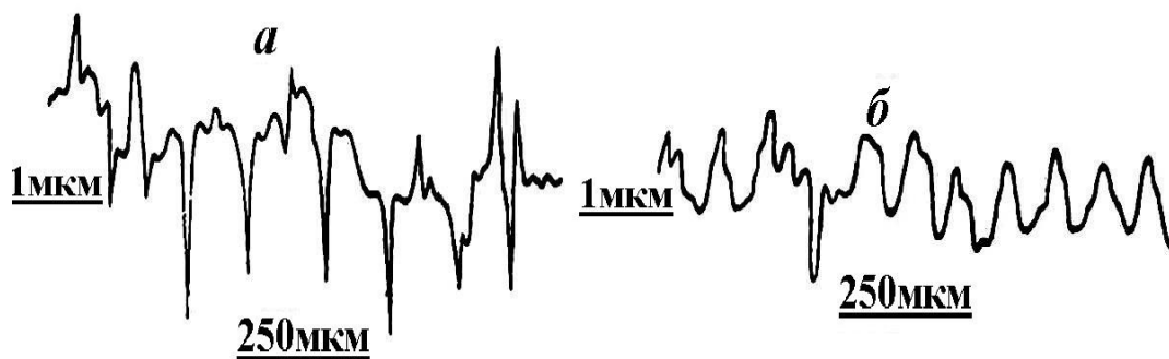
Рис. 5. Профилограммы поверхностей спеченных роликов: а - до; б - после ЭМО.
