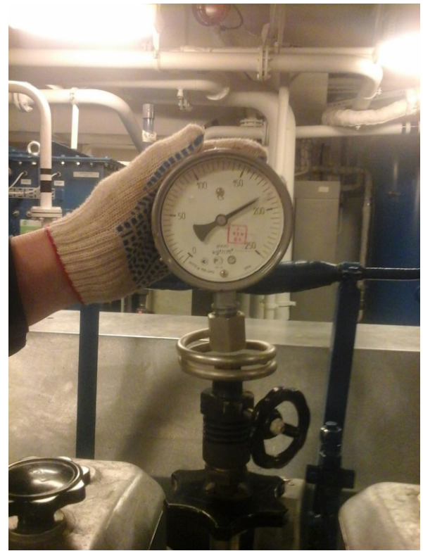
Şəkil 3. 6L20 markalı mühərrikin silindrindəki təzyiqin ölçülməsi
