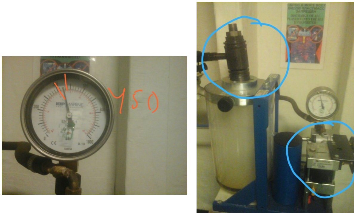
Şəkil 5. Forsunkanın başlanğıc püskürmə təzyiqinin yoxlanması və tənzimlənməsi
