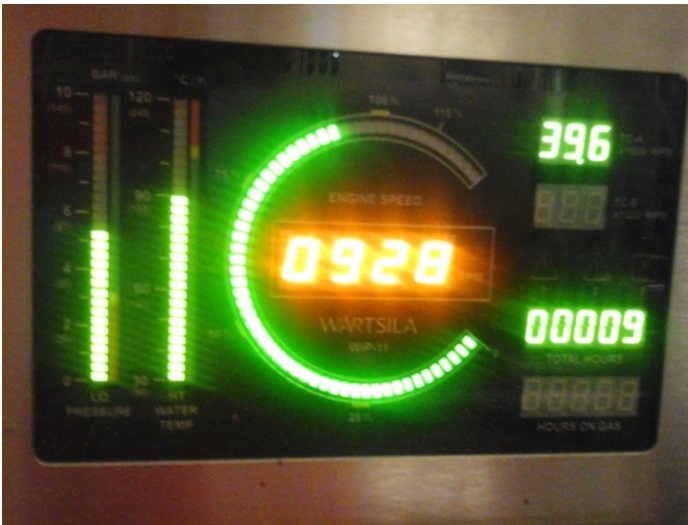
Şəkil 2. 6L20 markalı mühərrikin dövrlər sayının ölçülməsi
