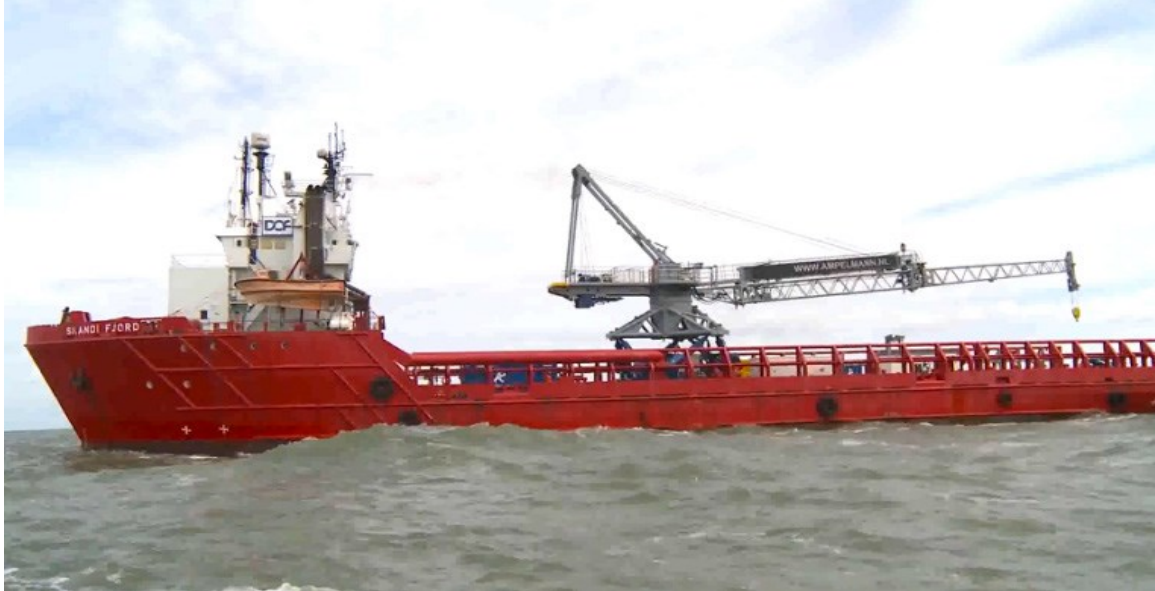
Şəkil 5. Gəmidə quraşdırılan Ampelmann E-8000 platforması
