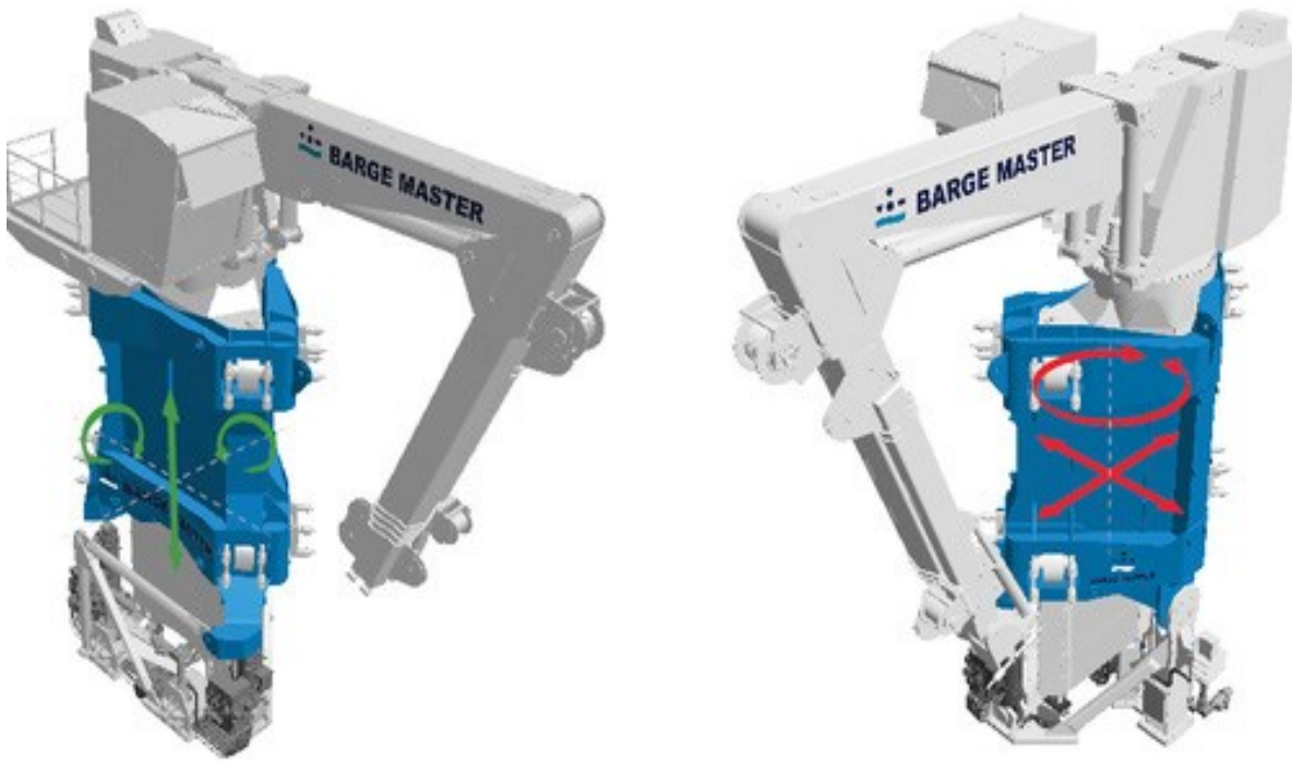
Şəkil 7. 6 sərbəstlik dərəcəli BM-T40 yükqaldırıcı kran
