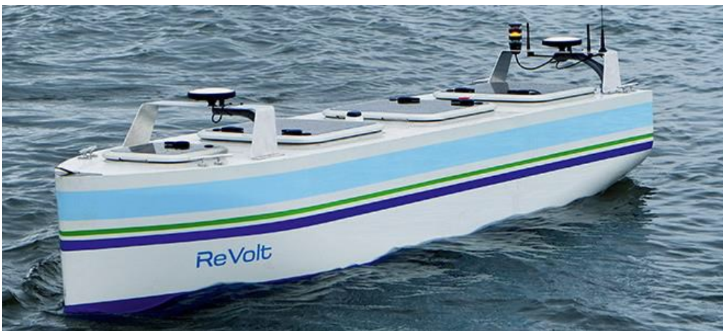
Şəkil 1. “ReVolt” sıfır emissiyalı ( batareya ilə işləyən) avtonom gəmi konsepsiyası
