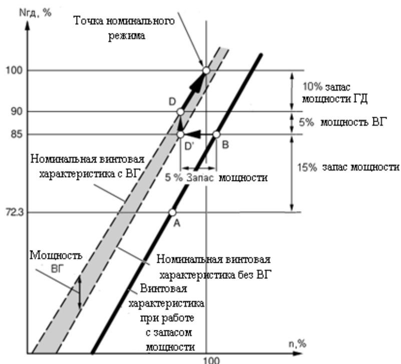
Рис. 9. Порядок определения мощности валогенератора
