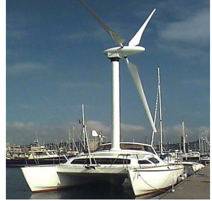
Şəkil 5. "Revelation II" gəmisində külək enerjisinin tətbiqi
