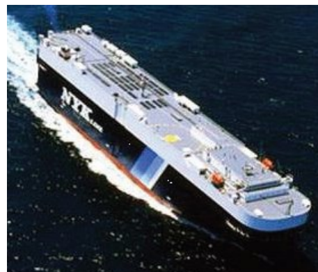
Şəkil 3. "M / V Auriga Leader" gəminin günəş enerjisi icrası
