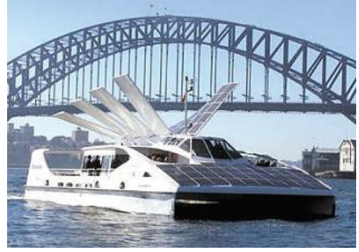
Şəkil 1. "SolarSailor" gəmisində günəş və külək enerjisi icrası
