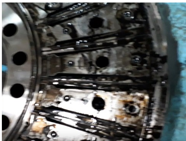
Рисунок 8. Состояние пружинных элементов демпфера
