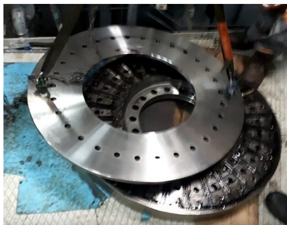
Рисунок 6. Демонтаж крышки демпфера
