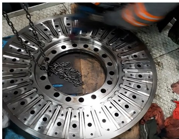
Рисунок 9. Состояние внутренних элементов после очистки
