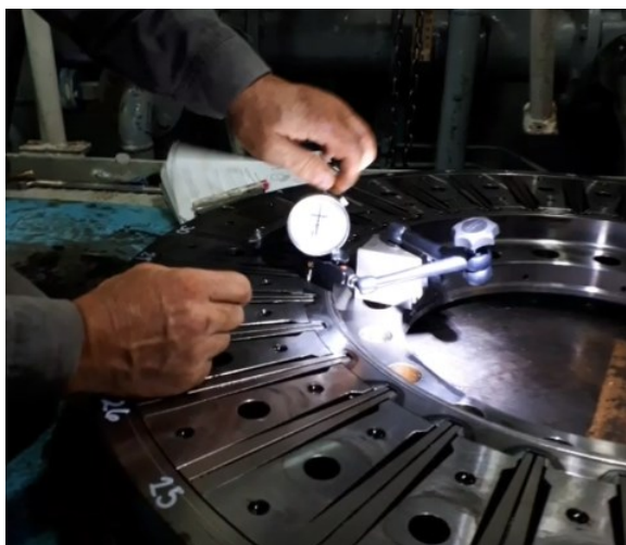
Рисунок 12. Оценка зазоров в пружинных элементах демпферов
