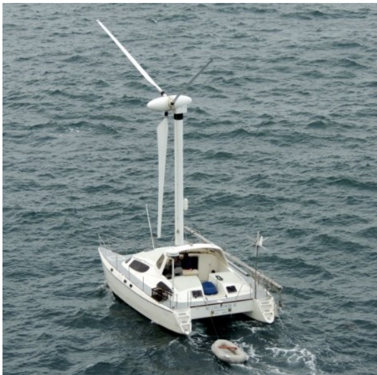
Şəkil 5. "Revelation II" gəmisində külək enerjisinin tətbiqi
