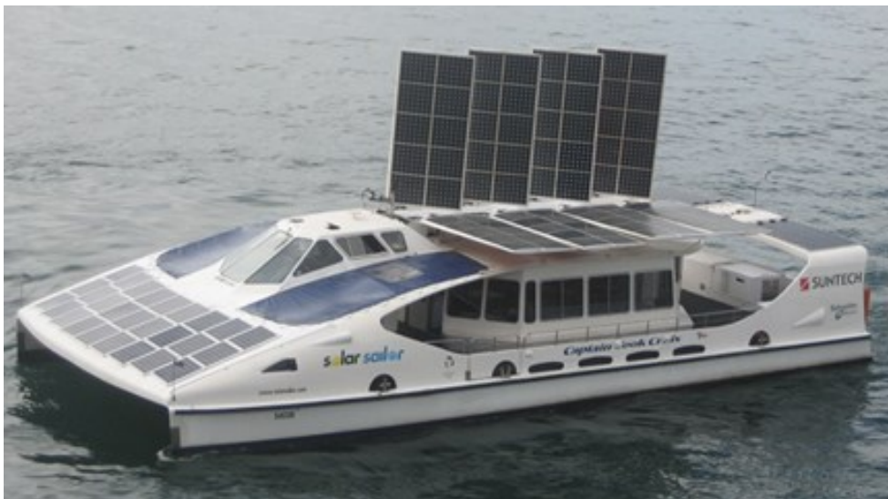
Şəkil 4. "SolarSailor" gəmisində günəş və külək enerjisi icrası
