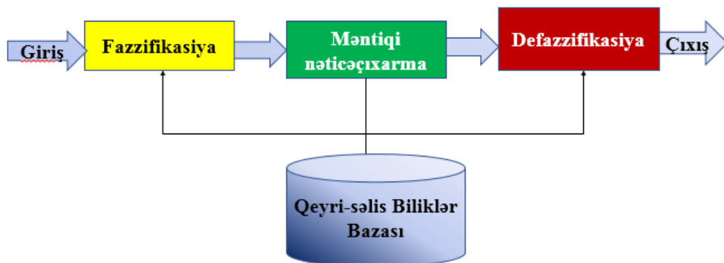
Şəkil 1. Qeyri-səlis nəticə çıxarma sistemlərinin ümumi arxitekturası
