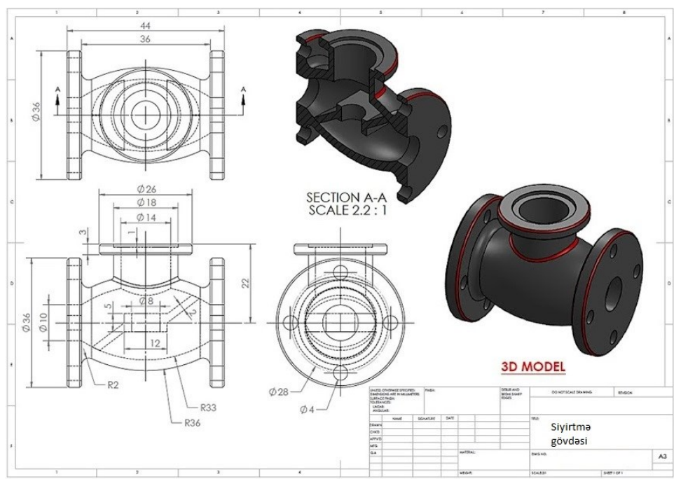
Şəkil 1. SolidWorks programında siyirtmə gövdəsinin hazırlanması üçün 3D modeli
