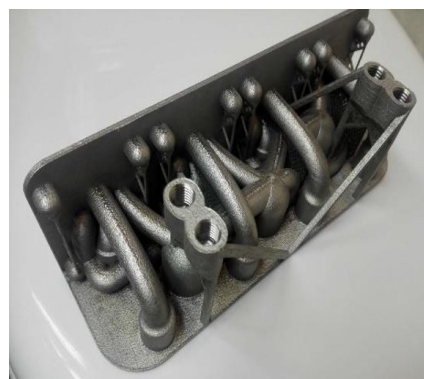
Şəkil 3. 3D çapı ilə hazırlanmış metal hidravlik kollektorlar
