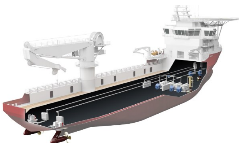
Şəkil 1. Elektrik hərəkətverici sistemi (EHS) əsasında vahid elektroenergetika sistemli gəminin görünüşü
