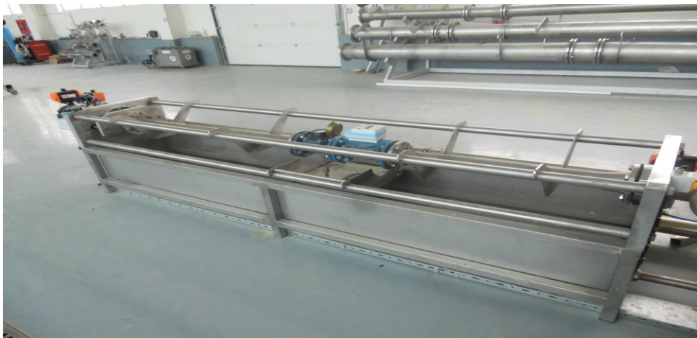
Şəkil 5. Böyük diametrlı suölçən cihazlar üçün xəta əyrisinin təyini stendi
