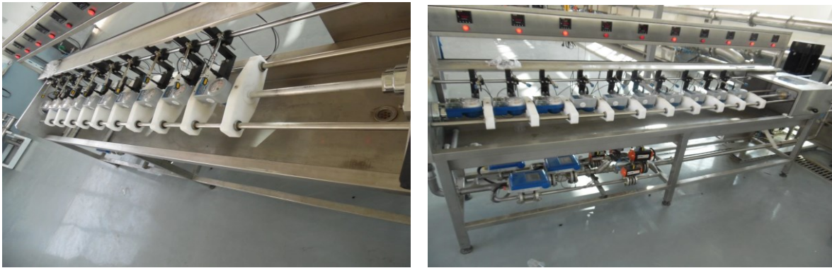
Şəkil 1. Suölçən cihazların avadanlıqda quraşdırılması
