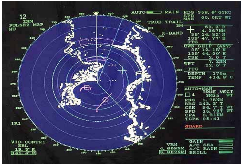
Şəkil 2. Radio ilə aşkarlama və hədəflərin təyini sistemində Avtomatik Radar Çəkiliş Qurğusunun simvolları əks edilmiş ekran görünüşü
