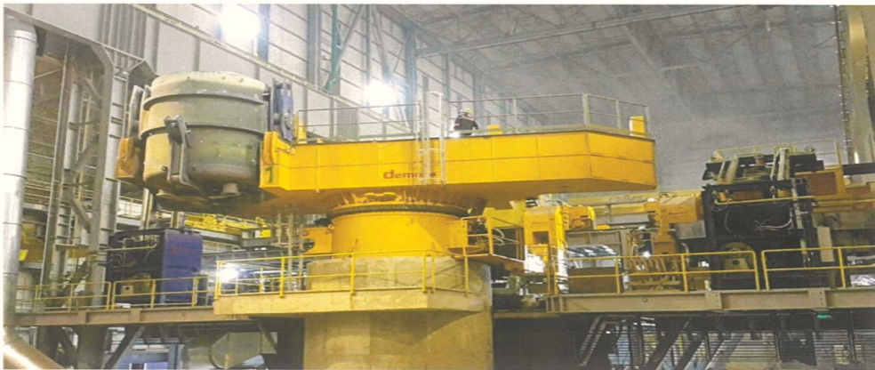
Şəkil 2. Maye metal çalovunun PFTM-ə yerləşmə qurğusu
