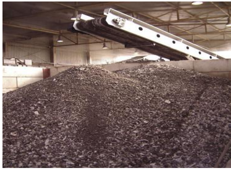
Şək. 2. Dib külünün ələndikdən sonrakı son vəziyyəti
