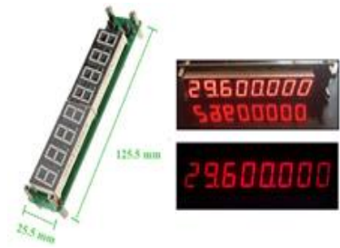
Şək. 2. Səkkizrəqəmli tezlikölçən cihaz
