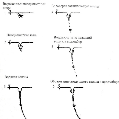
Рис. 1- Классификация типов вихревых воронок (Хеккер 1987)
