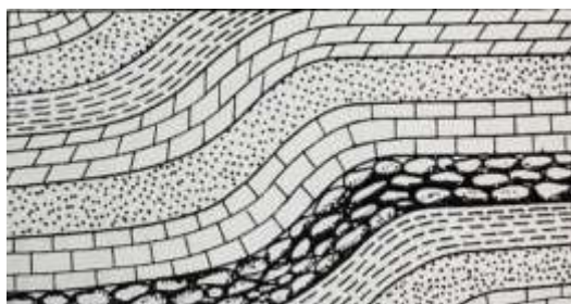
Şəkil 2. Sinklinal süxur
