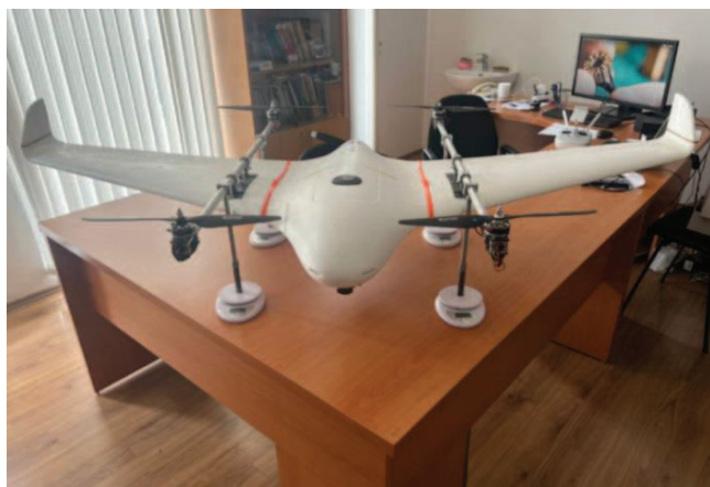
Şəkil 4. Konvertoplan tipli PUA-nın AM-nin təyin olunması məqsədi ilə laboratoriyada hazırlanmış işçi yer
