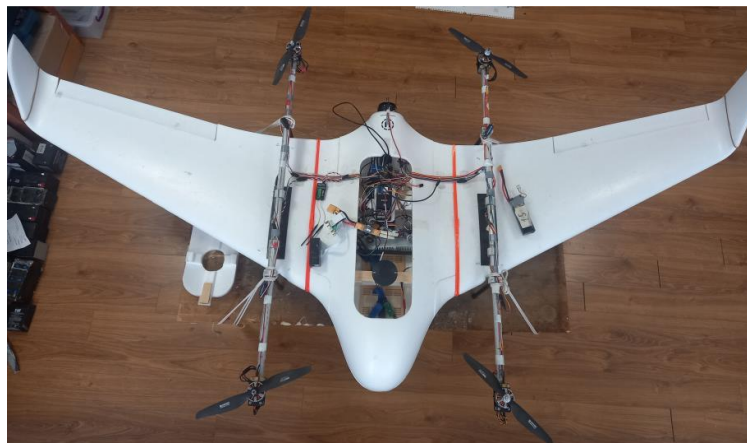
Şəkil 1. BNÖS quraşdırılmış konvertoplan tipli PUA
