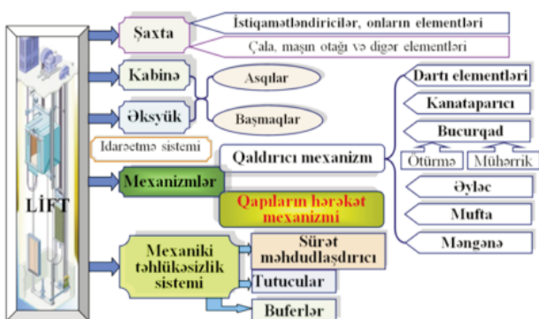
Şəkil 1. Liftin struktur sxemi
