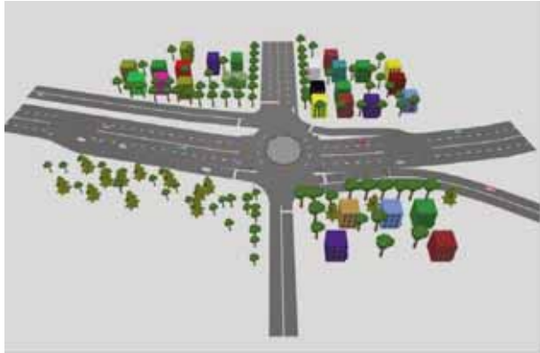
Şəkil 9. Bakı-Şamaxı yolunun Qobustan şəhərindən keçən hissəsində təklif olunan tunnel-dairəvi kəsişmə variantının simulyasiya modelinin görüntüsü
