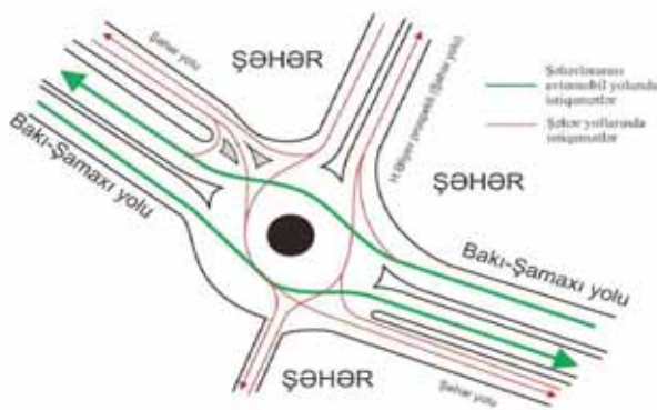
Şəkil 2. Dairəvi nəqliyyat açılmasında nəqliyyat axınlarının hərəkət istiqamətləri
