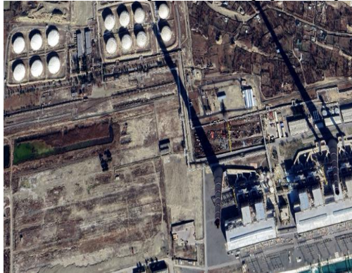
Şəkil 1. "Azərbaycan İES"-də Mazut çənlərinin yerləşmə sxemi
