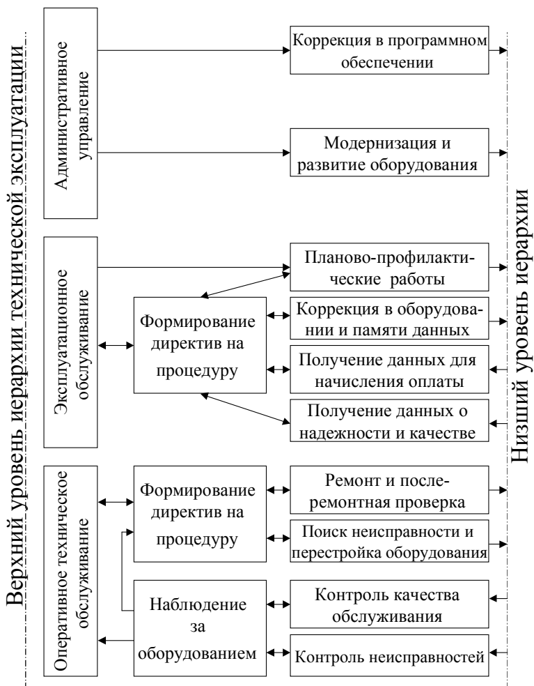
Рис. 1.13. Пример технической эксплуатации цифровых АТС.
