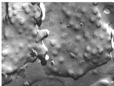
Рис.2.4. Микрофотография структуры композиции СКЭПТ-40-СКФ-26 в соотношении 50:50
